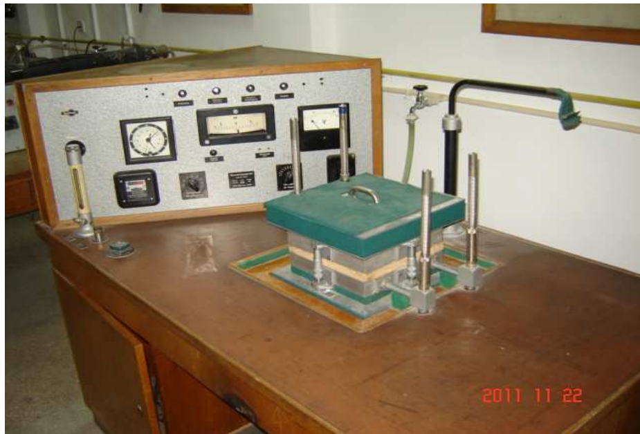
Fig.4. Stand pentru determinarea coeficientului de conductie la materialele izolatoare de tip Dr. Bock.
