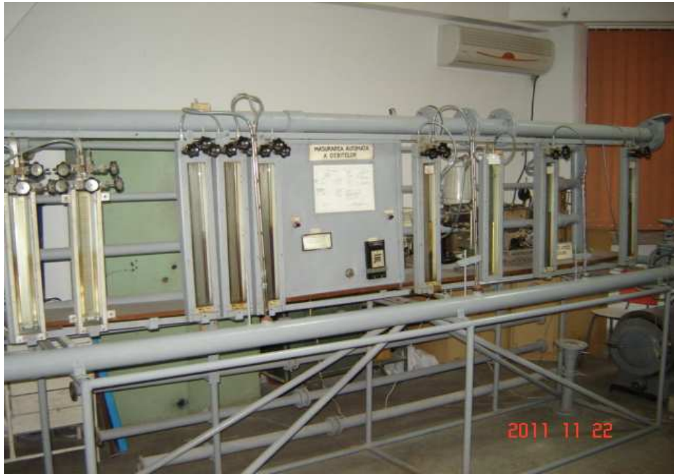
Fig. 1. Stand pentru masurarea debitelor, vitezelor si a presiunilor statice, dinamice si totale la curgerea gazelor prin conducte
