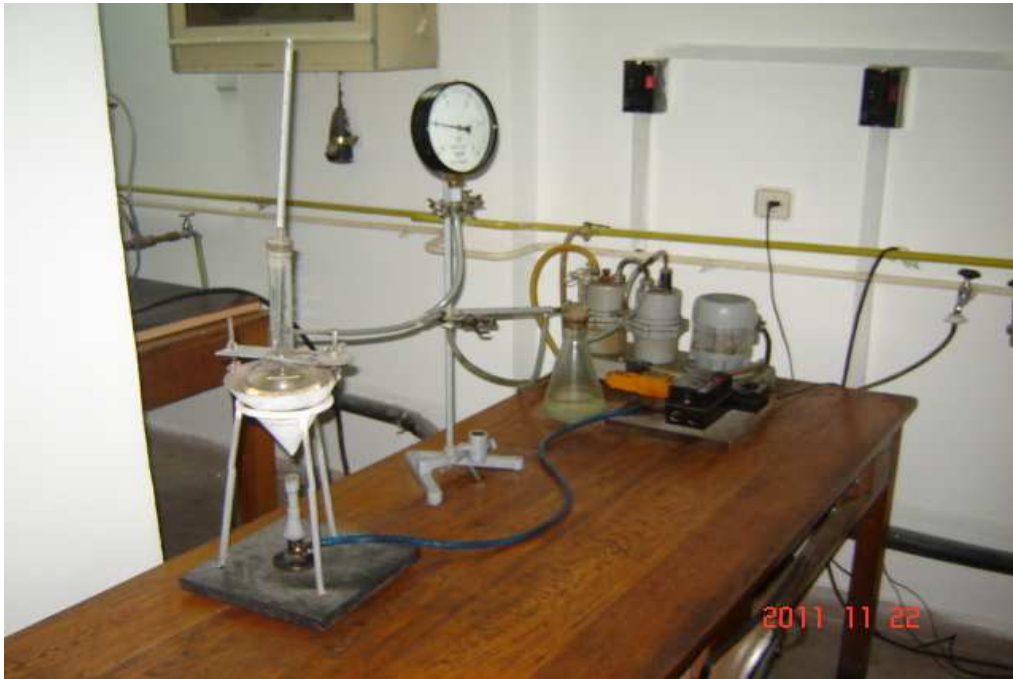
Fig.5. Stand pentru determinarea dependentei dintre presiunea si temperatura de vaporizare
