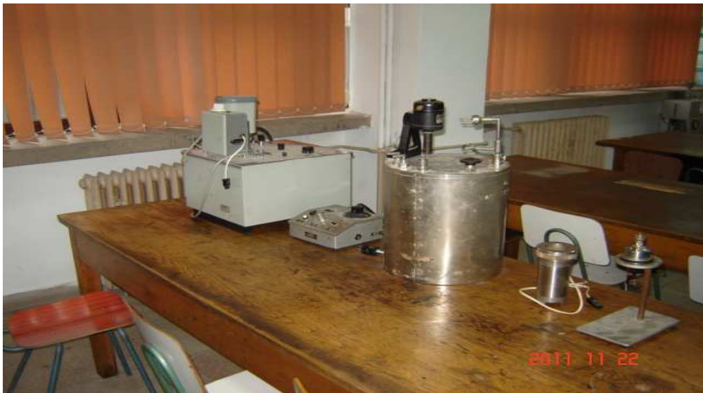
Fig.6. Stand pentru determinarea puterii calorice la combustibilii solizi și lichizi cu bomba calorimetrică
