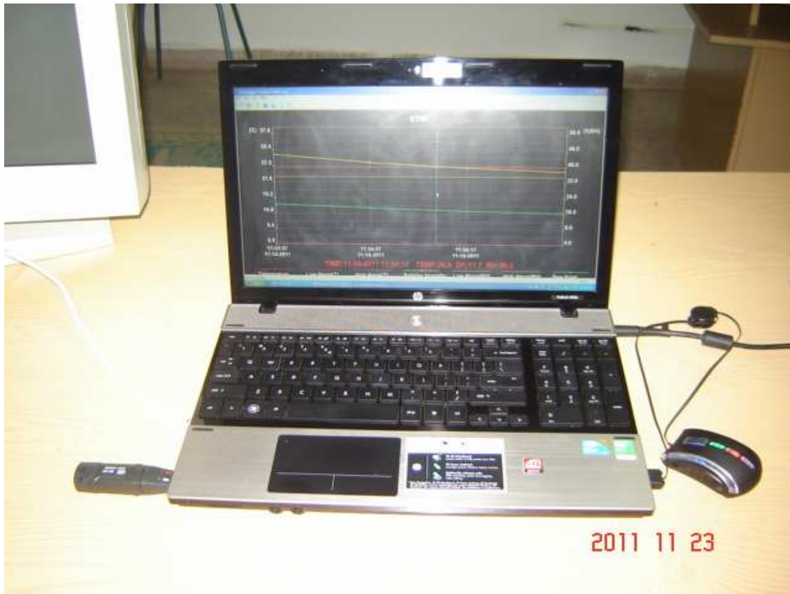
Fig.1. Psihrometru electronic pentru determinarea umiditatii aerului
