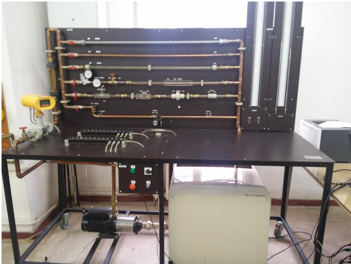
Figura 2 – Standul experimental SES 202 (vedere a întregului stand)
