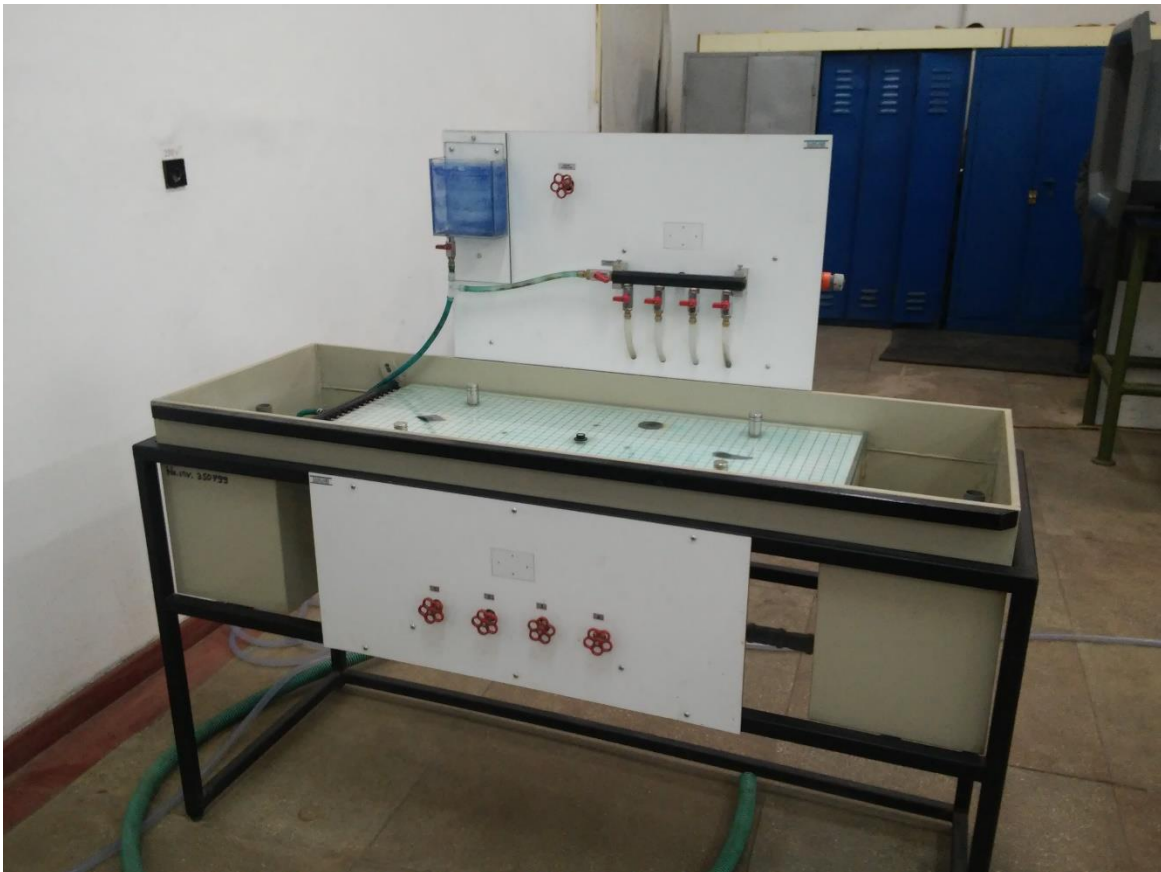
Fig. 1a. Instalație de vizualizare a curgerii potențiale
