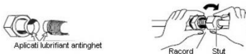
Fig.12. Racordarea conductelor de cupru
